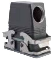
イルメ社の特許技術であるプラズマチタンコーティングを施した腐食に大変強いエンクロージャです。塩水噴霧試験で3000時間耐える耐腐食性を有しています。
